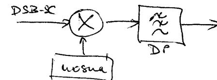
SSB: posunutí jednostranného spektra o  $\omega_s$ , řeší se analytickým filtrem, modulaci ~ DSB-SC a výběrem  $\operatorname{Re}\{s\}$
